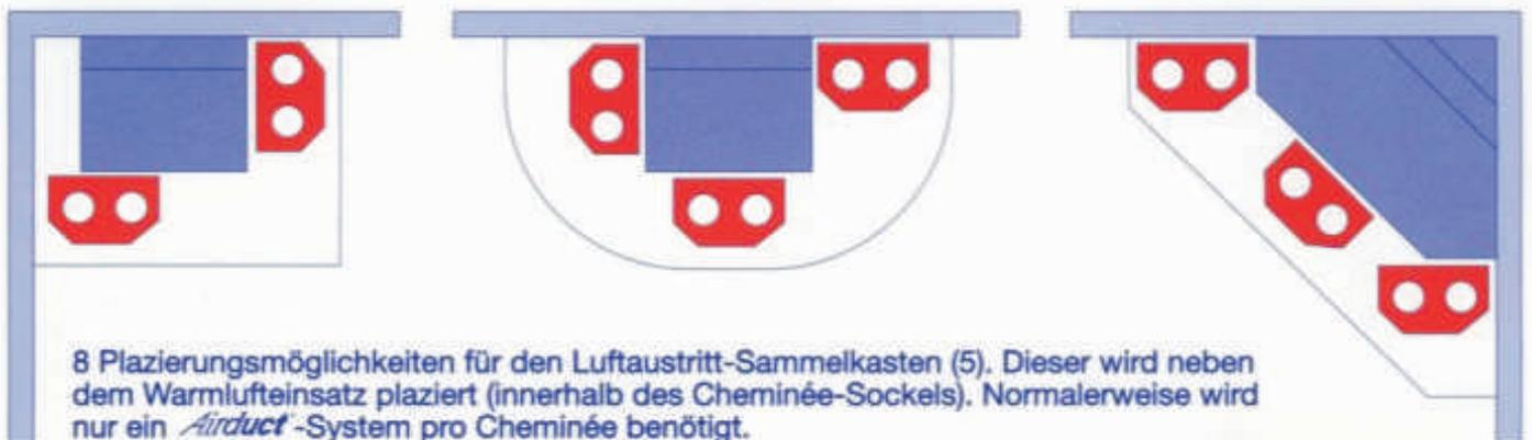
8 Platzierungsmöglichkeiten für den Luftaustritt-Sammelkasten (5). Dieser wird neben dem Warmlufteinsatz platziert (innerhalb des Cheminée-Sockels). Normalerweise wird nur ein *Airduct*-System pro Cheminée benötigt.
